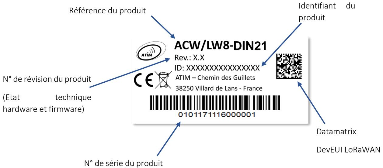
Chaque produit de la gamme ACW d'ATIM possède une étiquette QR Code visible soit sur le flanc, soit sur la face avant du produit. Ce QR Code peut être facilement lu avec n'importe quelle application de lecture de code-barre 2D sur smartphone.
